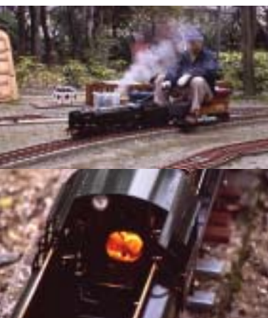
SLは本物さながらに油の染みた薪で火をおこし石炭をくべる。蒸気圧を安定させるのが難しく、一日の運行数も限られるが、そこが格別の楽しさという
